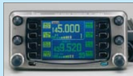
Dieser vollwertige Twinbander IC-2800H ist als solcher unschwer an doppelt vorhandenen Lautstärke- und Squelch-Stellern erkennbar. Werkfoto
