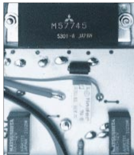
Bild 2: Das Mitsubishi-Modul als Kernstück der Linearendstufe ermöglicht eine schnelle Inbetriebnahme.
