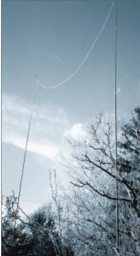
Bild 7: Quadelement für 20 m aus TW-85-Draht und zwei Glasfibernasten
