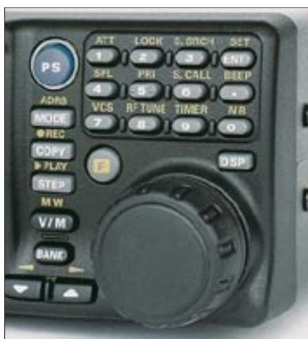
Die rechte Gehäusesseite bietet Platz für einen VFO-Knopf und ein Tastenfeld, über das eine direkte Frequenzeingabe erfolgt bzw. weitere Funktionen und Menüs aufgerufen werden.
